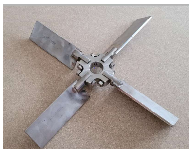
Turbina depois de aberta ( \varnothing 400 mm)
